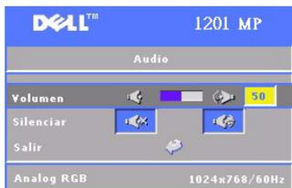
**VOLUMEN**—Pulse el botón  $\ominus$  del panel de control o el botón - del mando a distancia para disminuir el volumen, y pulse el botón  $\oplus$  del panel de control o el botón + del mando a distancia para aumentar el volumen.
