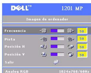
**FRECUENCIA**—Cambie la frecuencia de datos de pantalla para que coincida con la frecuencia de la tarjeta gráfica de su ordenador. Si aparece una línea vertical que parpadea, utilice el control de frecuencia para minimizar las barras. Se trata de un ajuste aproximado.
