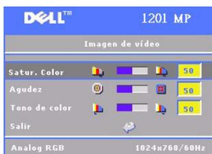
**SATUR. COLOR**—Pulse el botón  $\ominus$  del panel de control o el botón  $\blacktriangleleft$  del mando a distancia para disminuir la cantidad de color de la imagen, y pulse el botón  $\oplus$  del panel de control o el botón  $\blacktriangleright$  del mando a distancia para aumentar la cantidad de color de la imagen.
